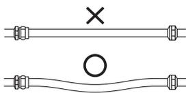
②極端な屈曲や無理な湾曲での接続は寿命を縮めます。小さな曲がり部には、エルボを使用し、最小曲率半径以上にて作動するよう取付けてください。
