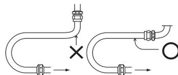
③ねじれが発生しないようお取付けください。繰返し変位が発生する場合、変位の方向と製品の曲げが同一平面になるように取付けし、ねじれを避けてください。(ねじれたまま取付けられ内圧が加わると、異常応力が発生しブレードが破損してチューブが破けたり、継手金具がゆるんだり、漏れの原因となります。)
