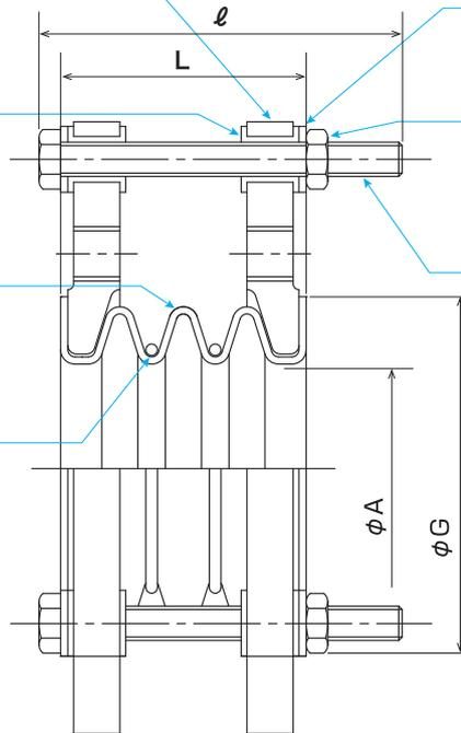
ストッパーボルトは取外さないでください。出荷時には、標準面間寸法になっています。許容伸縮量の範囲で必要に応じて調整してください。
