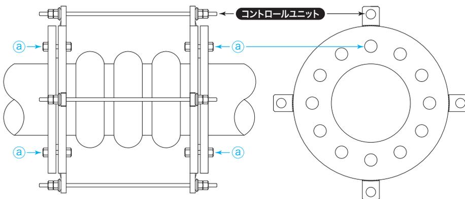
※製品側フランジにプレート<sup>①</sup>を直接溶接します。
