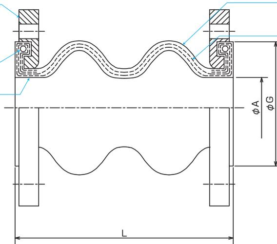
●JIS10Kフランジ(SS400)装着が標準品です。JIS5K・JIS20K・上水・ANSIなど各規格フランジに変更可能です。
