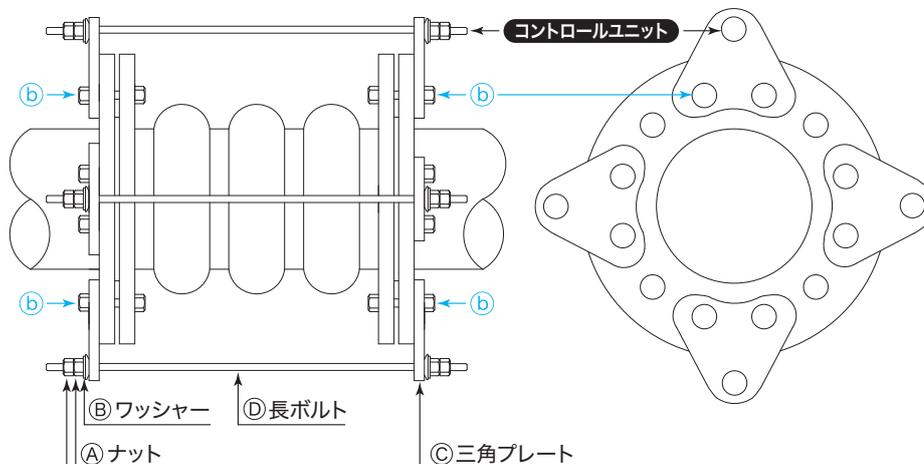
※相手フランジに三角プレート<sup>③</sup>を取付けます。
