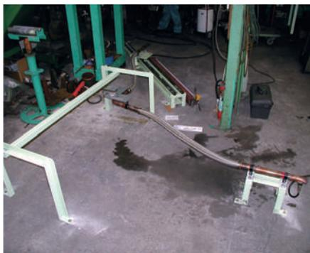
最大反力・最大変位試験
