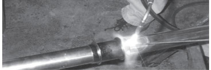
⚠ ろう材が全周で確実に回っていないと、応力による割れ等を発生させる危険があります。
